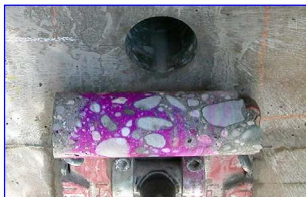
L'analisi va condotta subito dopo il prelievo della carota per evitare che si formi un film superficiale carbonatato lungo tutta la superficie che impedirebbe la reazione con la fenoftaleina.
