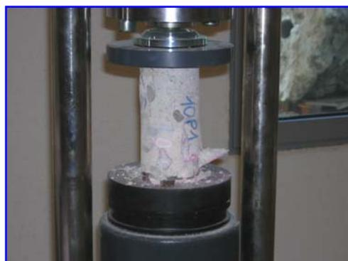
Il valore della resistenza cubica è ottenuta da quella cilindrica attraverso la relazione (Art. 4.0.2 del D.M. 9 gennaio 1996):
