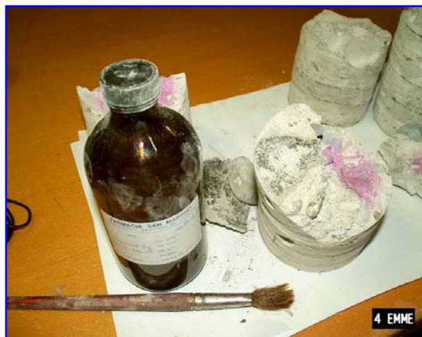
In questo stato il calcestruzzo è fortemente permeabile e riduce la capacità protettiva; fornisce inoltre, allo strato superficiale, una durezza superiore che tende ad ingannare i metodi di determinazione della resistenza a compressione misurati con sclerometro e pull-out.
