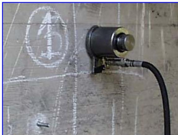
Il valore della forza massima necessaria consente, attraverso delle curve sperimentali di correlazione, di pervenire al valore della  $R_{mc}$ . La rottura della parte sottoposta a tensione avviene per compressione-taglio tra la parte allargata del tassello e la base del martinetto.
